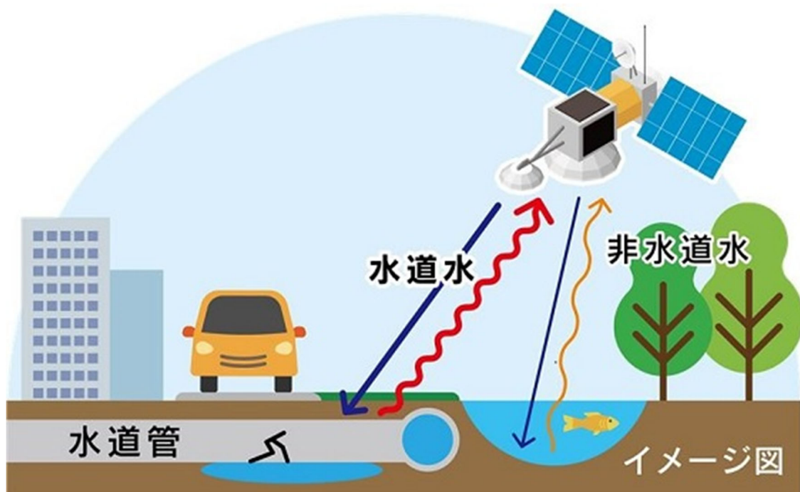
図 2.6.5 衛星画像と AI を活用した漏水調査
