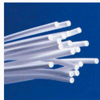
中空糸と、それから作られるウイルス 除去透過膜 (世界シェアNo. 1) や 人工透析膜
