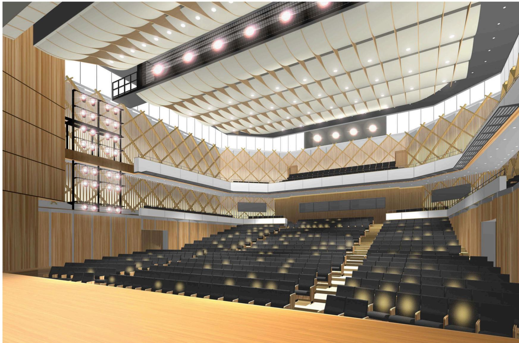
音楽を主目的とする、ホールに相応しい、明るく上品な空間を目指します。二層分の高さの壁が、客席の三方を取り囲み、親密な一体感のある空間を形成しています。この壁面に、市産材を利用した、木ルーバーを全面的に設置します。木ルーバーは、音を拡散させ、豊かな音響をつくりだすと同時に、木の素材感が、温もりのあるやさしい印象をつくりあげます。ルーバーは、斜材の枠組と縦の細丸太で構成され、延岡の伝統的風景である「鮎やな」をモチーフとした意匠としています。
