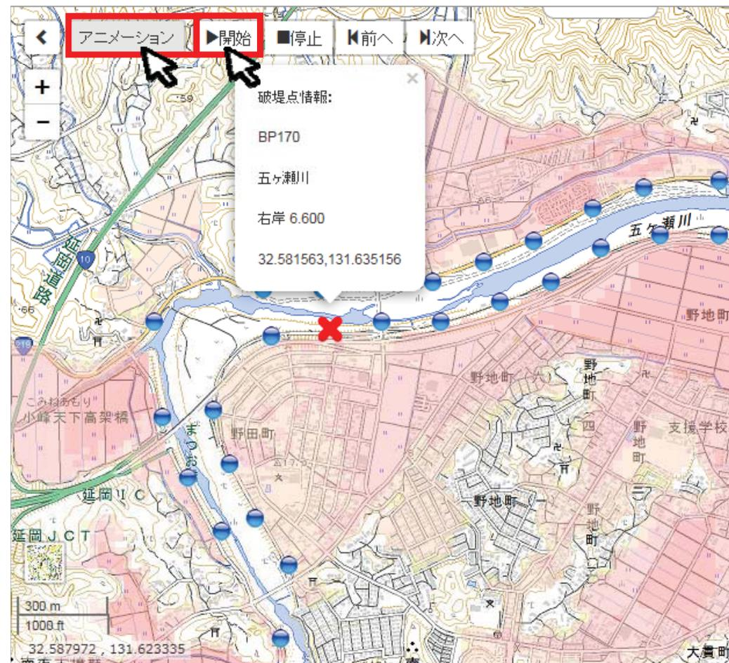
⑦選択した破堤点で堤防が決壊した場合の、浸水の広がり方が表示される。
