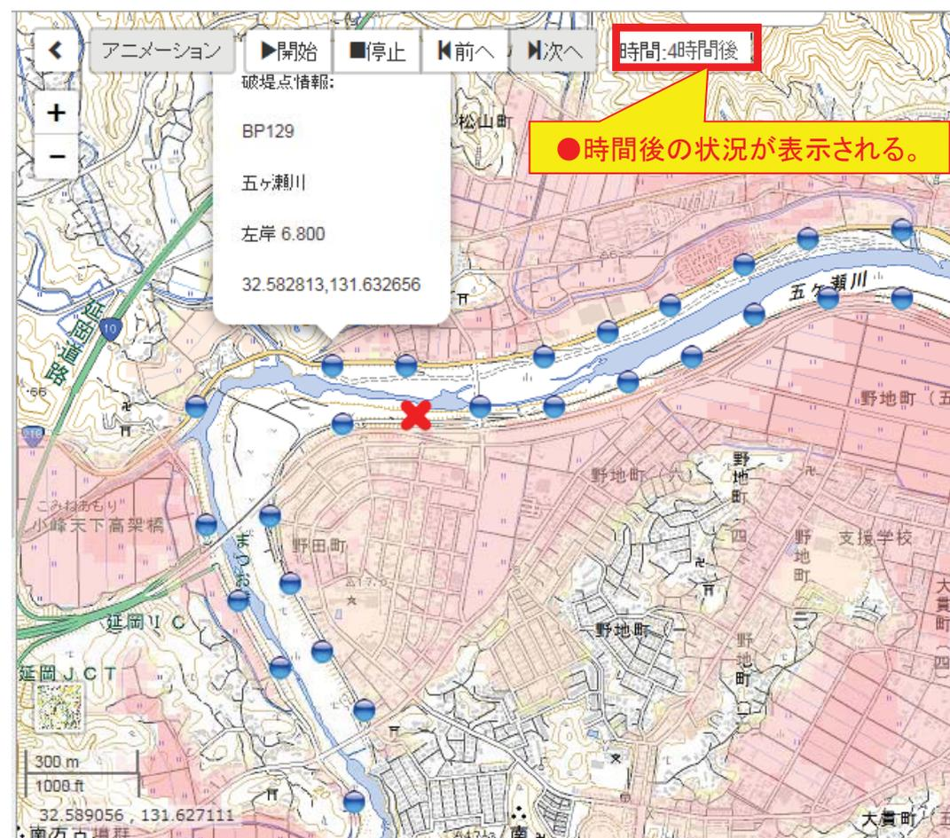
「浸水想定区域図」は、これらの破堤点における浸水範囲・浸水深の最大の浸水深を重ねあわせた図である。何分・何時間で自施設が浸水するか確認し、浸水開始までに避難できる備えをしておくことが重要である。
