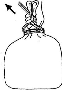
土のうの底部を丸く仕上げる。
