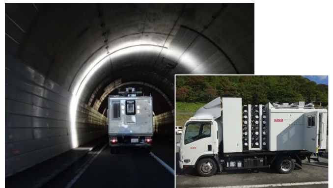
カメラ搭載型車両走行による点検 ※交通規制不要・点検精度向上
