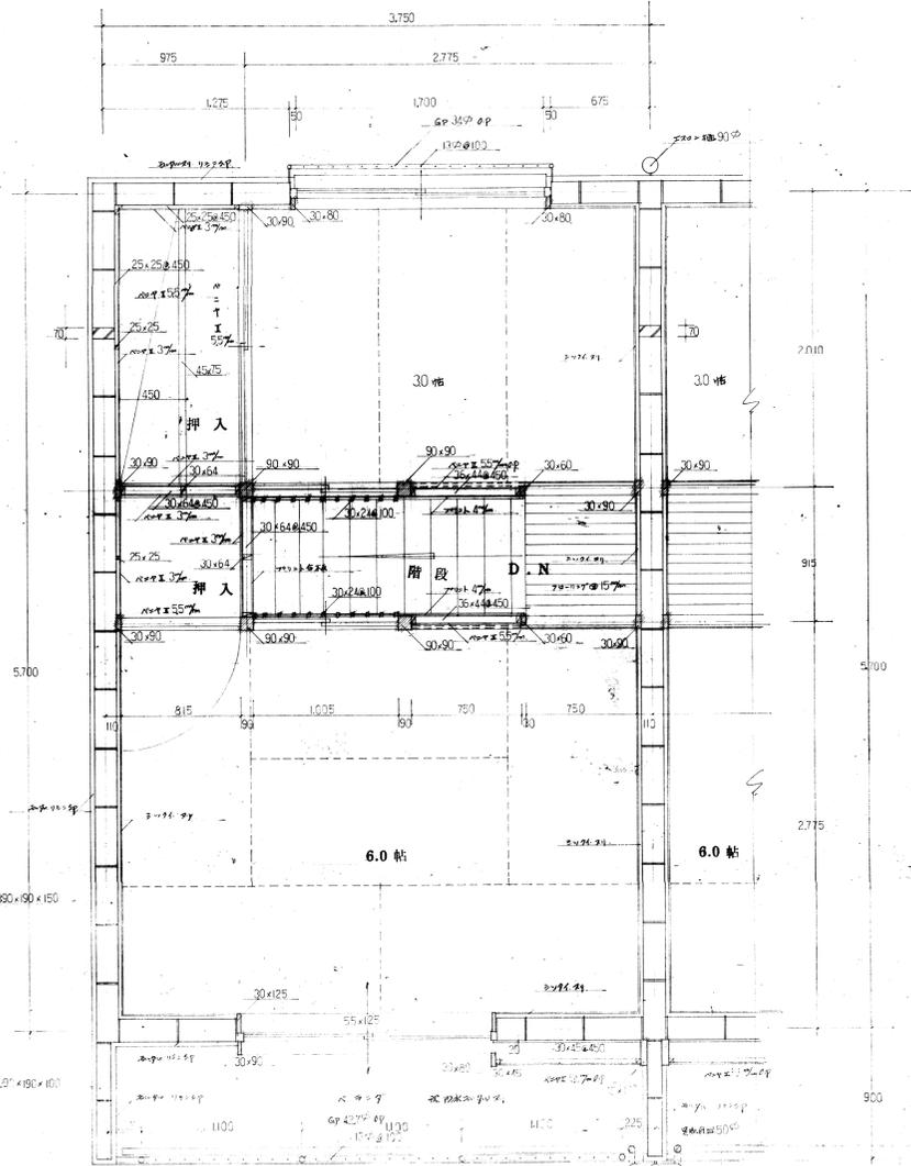
2階平面図 床面積 21.375㎡ s = 1/20
