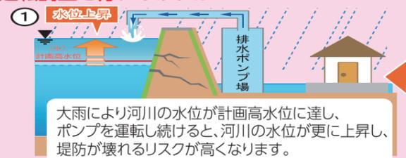
たくさんの雨が降れば、宅地側の浸水被害軽減のため、ポンプを運転します
